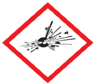
PELIGRO DE EXPLOSIVOS
