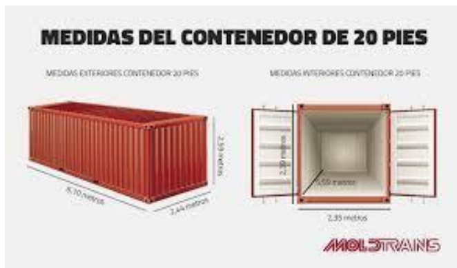
Ilustración 18 medidas del contenedor
