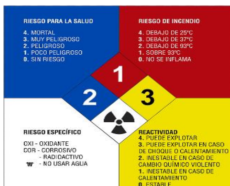
Figura 8 Señalización De La NFPA No. 704
